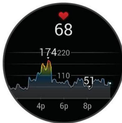
3 Проведите пальцем по экрану вверх, чтобы просмотреть значения частоты пульса в состоянии покоя (ЧП в состоянии покоя) за последние 7 дней.
